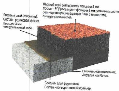
Наливное покрытие из резиновой крошки. Эти поверхности не подвержены коррозии и могут использоваться на открытом воздухе во влажном климате, не подвергаясь разрушительному воздействию осадков или других условий окружающей среды. Более того, при правильной установке они могут прослужить более 10 лет. Стоимость 2 500 000 руб. (предварительный расчет).
